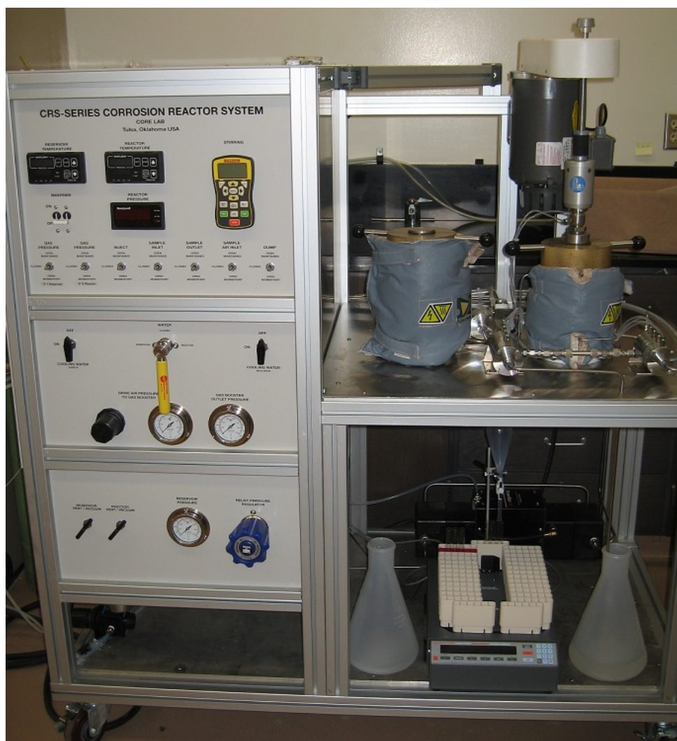
Fig. B.8—Rotating Disk Apparatus RDA 100.
