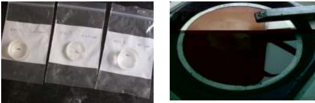
Fig. 21. CuAlBe samples and polishing
