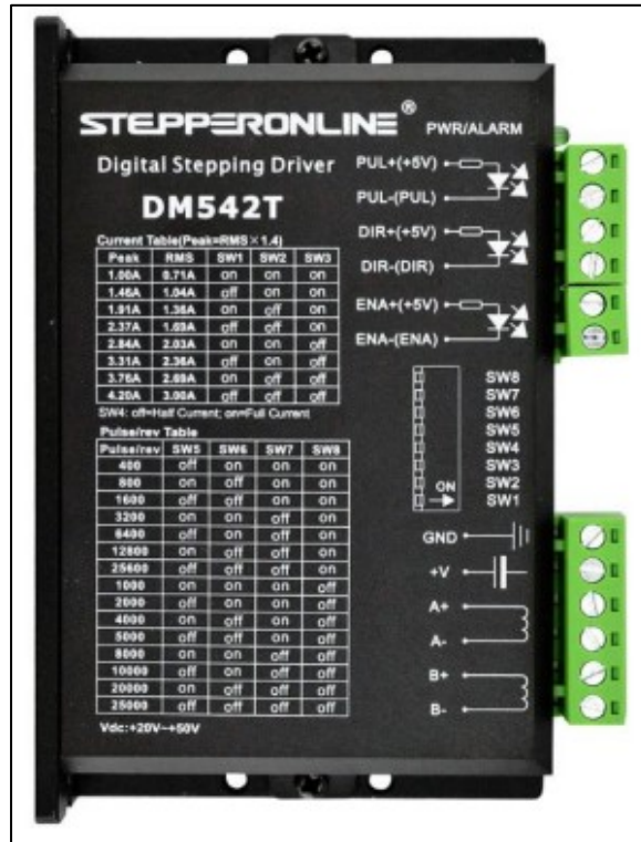
Figure 47. Stepper Motor Driver [28].
