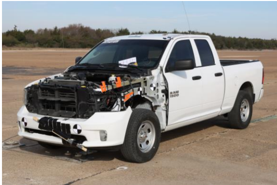
(d) 2270P test vehicle (after removing parts)
