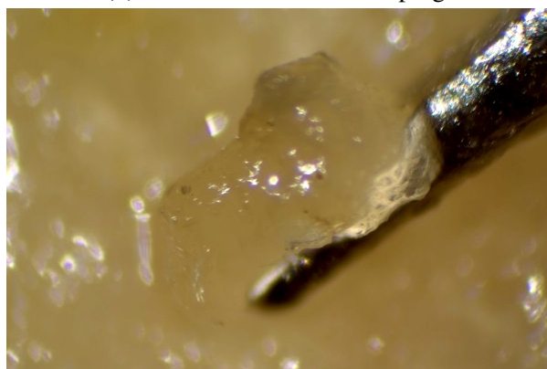
(d) 50% TMEVS Film Scrapings
