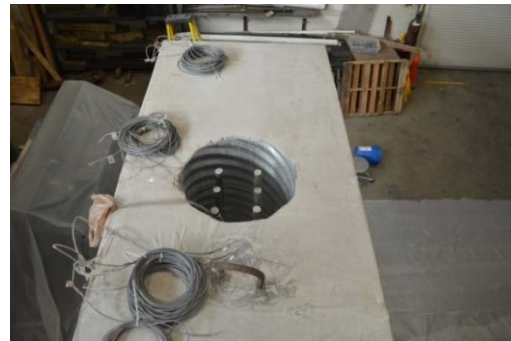
(d) Dowel in Pocket Connection
