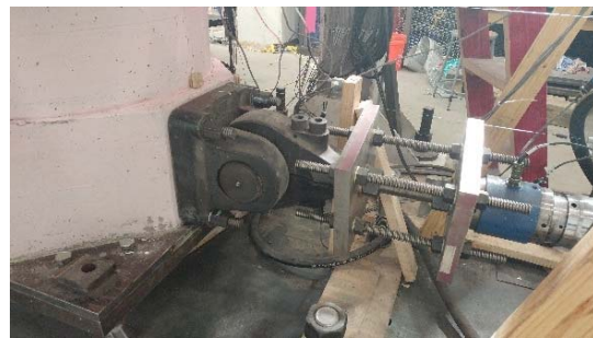
(d) Installed HB Actuator
