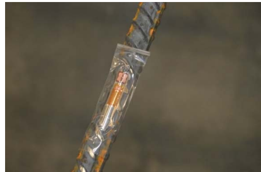
(d) Secure Placement of Strain Gage
