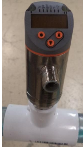
Figure 11. Flow Sensor SA 6010
