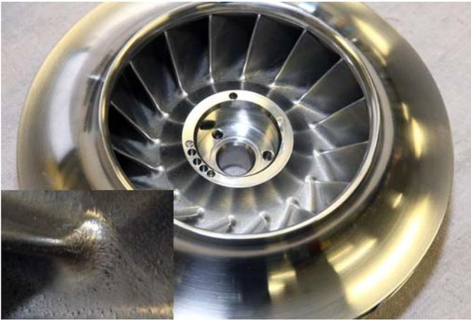
**Figure 9. 2<sup>nd</sup> Generation Inconel Impeller**
