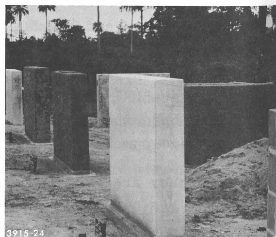
(d) Prototype walls under outdoor exposure tests
