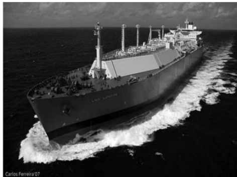
Figure 2: Membrane type LNG tanker 7
