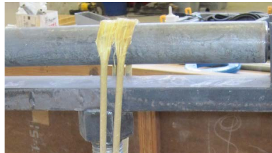
(d) Reshaping the bar
