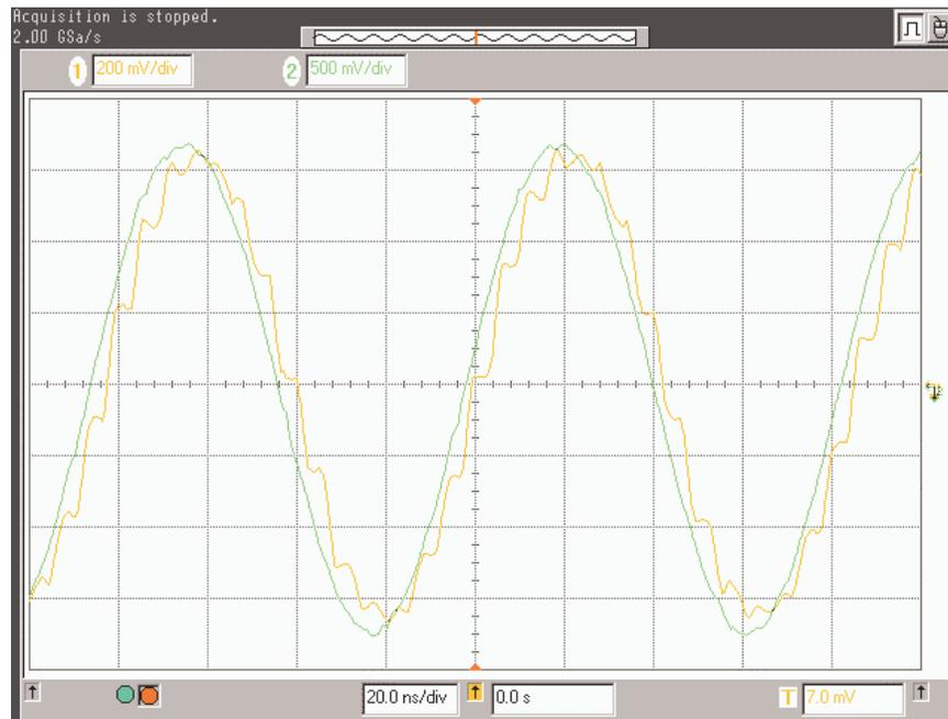
(a)  $F_{in}=12\text{MHz}$ ,  $F_{sample}=161\text{MS/s}$
