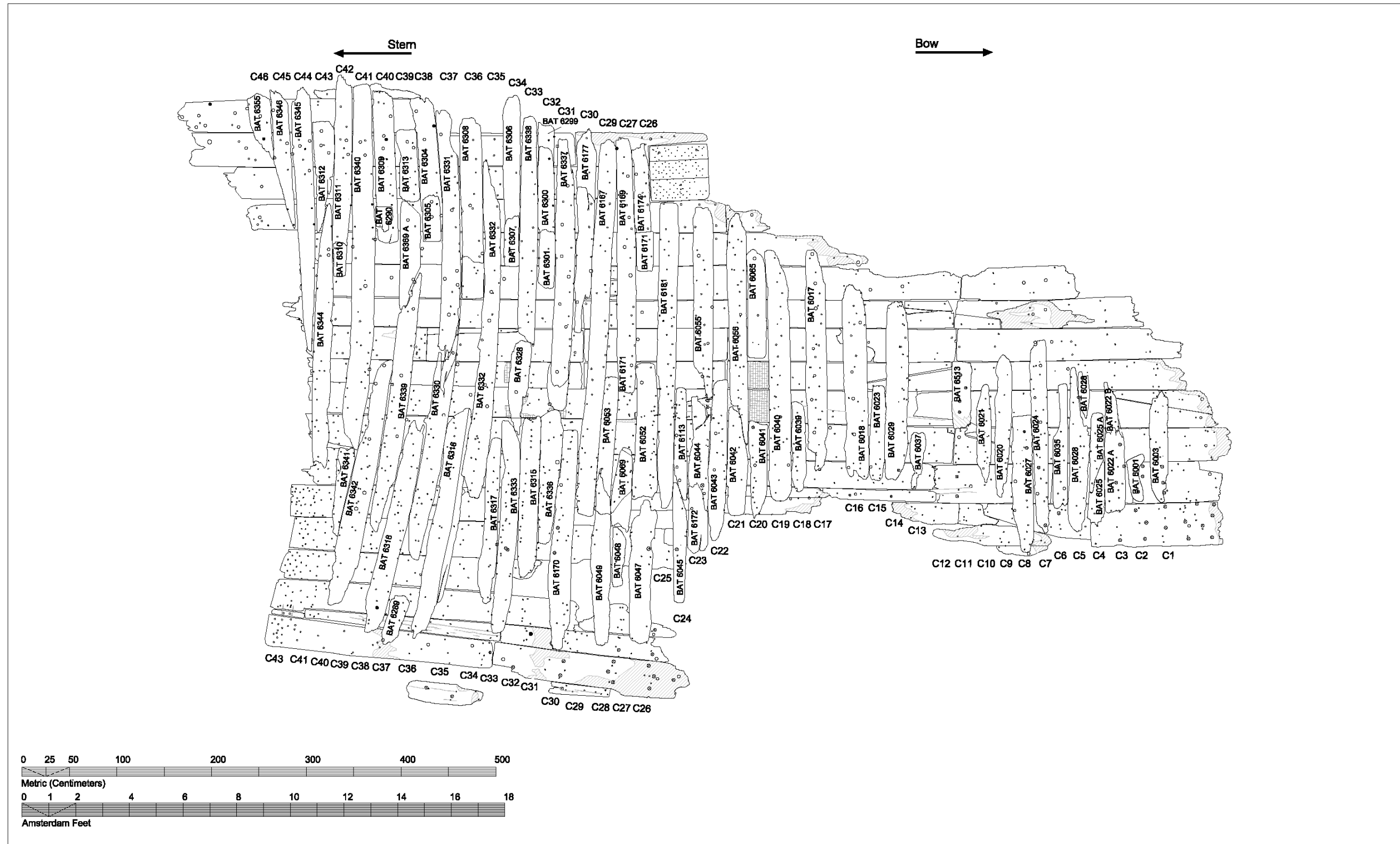
Fig. IV.53 Timber plan of Batavia 's frame timbers. Illustration: Wendy van Duivenvoorde.
