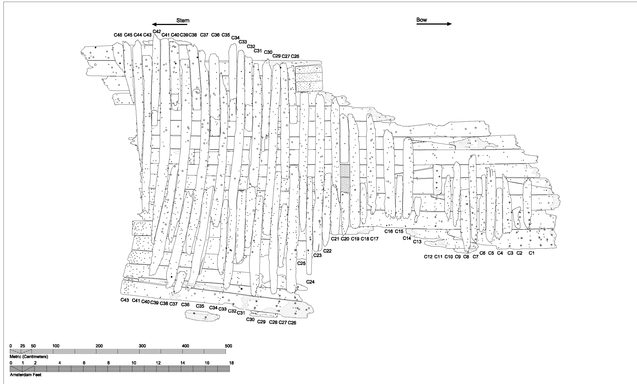
Fig. IV.54 Reconstructed plan of Batavia 's frame timbers. Illustration: Wendy van Duivenvoorde.
