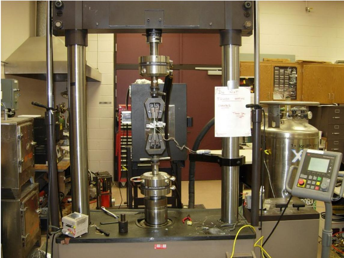
Fig. 8. The MTS 100 KIP load frame
