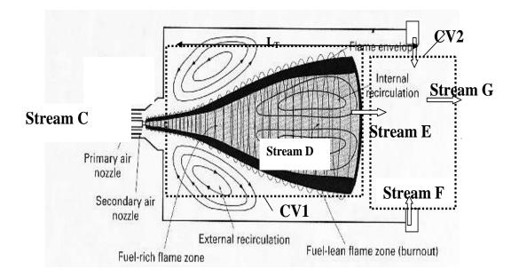
Figure 4.1 Actual LNB burner
