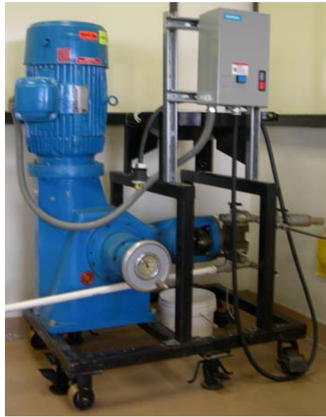
Fig. 4.9- Bran & Lubbe simplex plunger pump.
