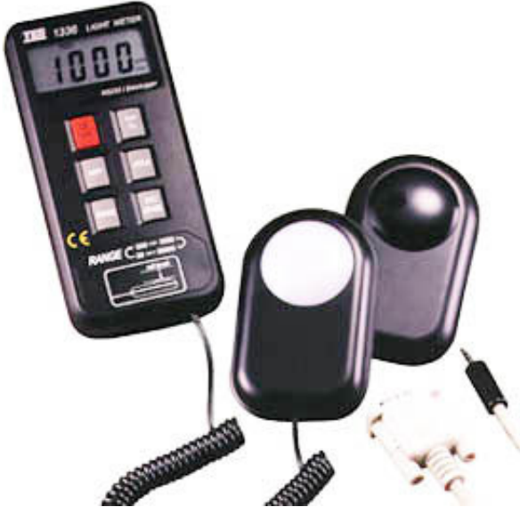
Fig. 15 Illuminance meter TES 1336 www. Seoultester.co.kr
