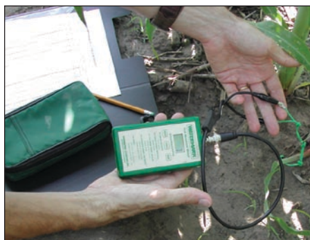
Figura 4. Utilizando el medidor portátil del sensor Watermark®.
