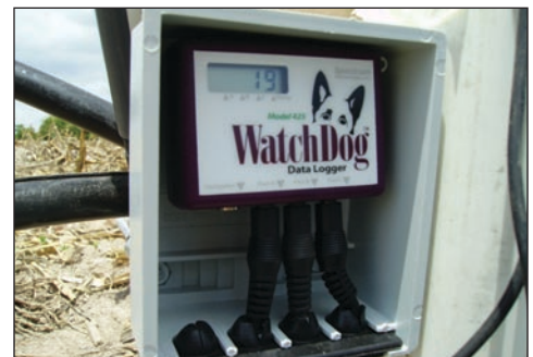
Figura 5. Sensores Watermark® conectados a un sistema de registro de datos WatchDog® (de hasta 3 sensores).
