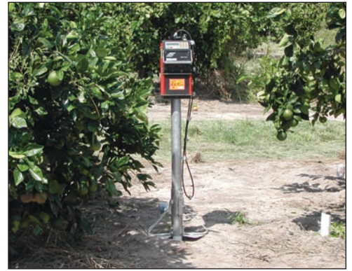
Figura 12. Sonda de neutrones utilizada en un cultivo de naranjas.
