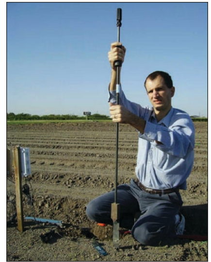
Figura 8. Uso de una herramienta especial para instalar sensores ECH 2 O®: una lámina de acero de la misma medida que el sensor se martilla hacia el suelo (arriba) antes de insertar y empujar el sensor con otra herramienta (abajo).
