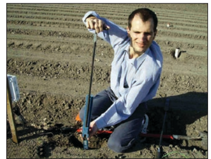
Figura 8. Uso de una herramienta especial para instalar sensores ECH 2 O®: una lámina de acero de la misma medida que el sensor se martilla hacia el suelo (arriba) antes de insertar y empujar el sensor con otra herramienta (abajo).
