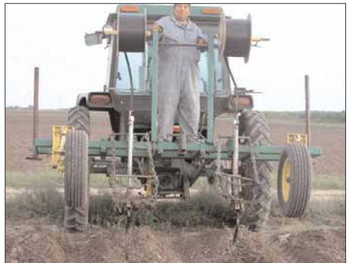
Figura 3. Implementos con inyectores de cinta de goteo.
