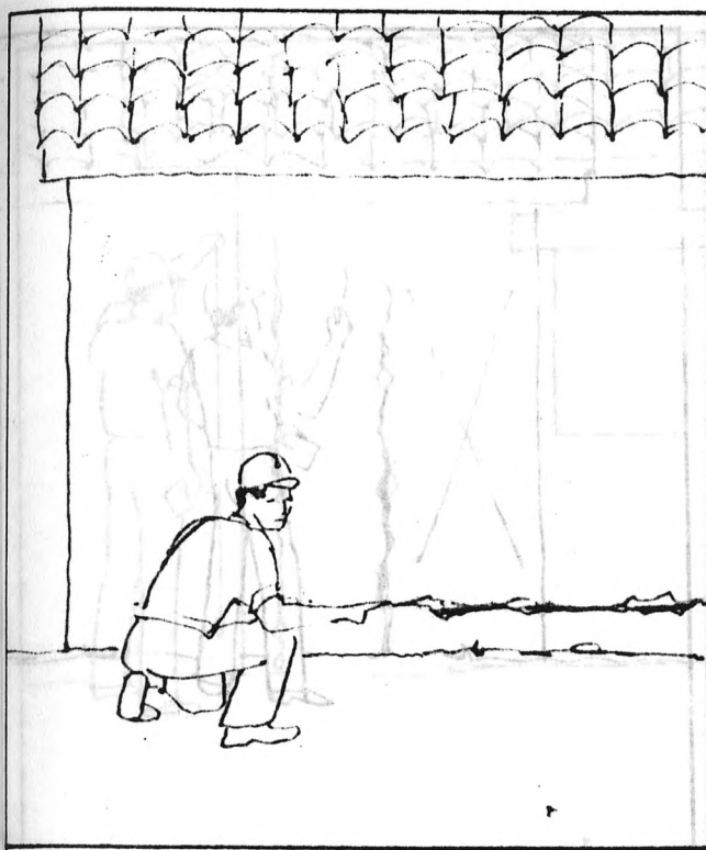
Identifique la grieta
