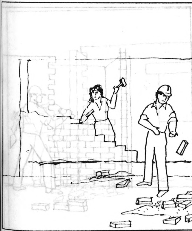
Haga demolición de la pared
