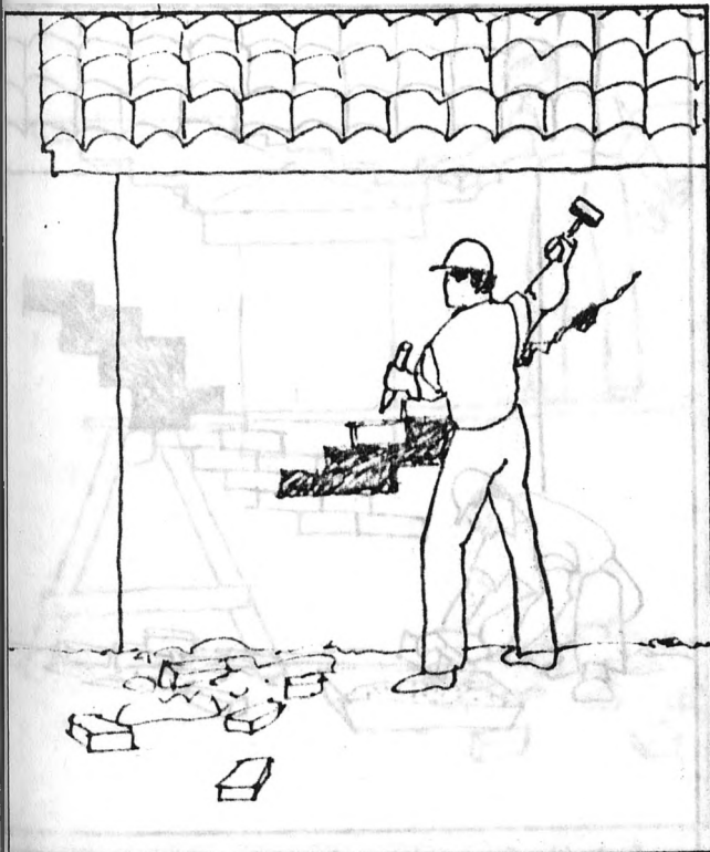
Quite los ladrillos debajo de la grieta y reconstruya el área
