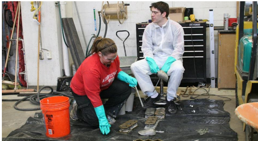
(d) Preparing grout cubes and cylinders
