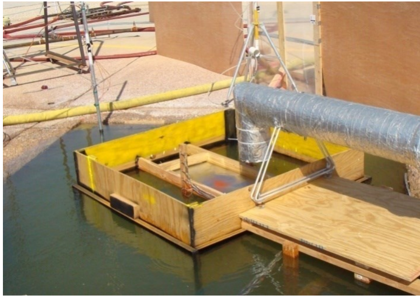
Fig. 30. LNG pool setup from March 2009 MKOPSC LNG experiment
