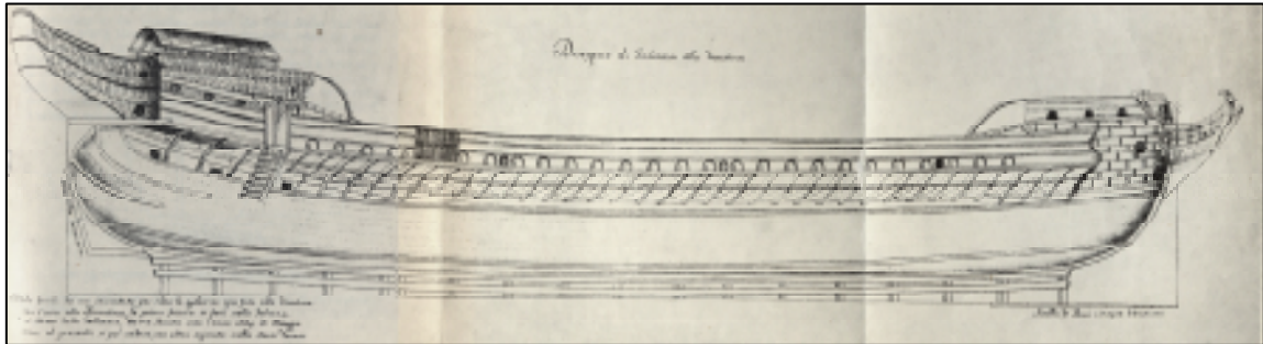
Fig. 4. Galleass “in the Fausto’s way” ( alla Faustina ). Stefano de Zuanne, Architettura navale , 1686. After: Anderson 1962, pl. 13B.
